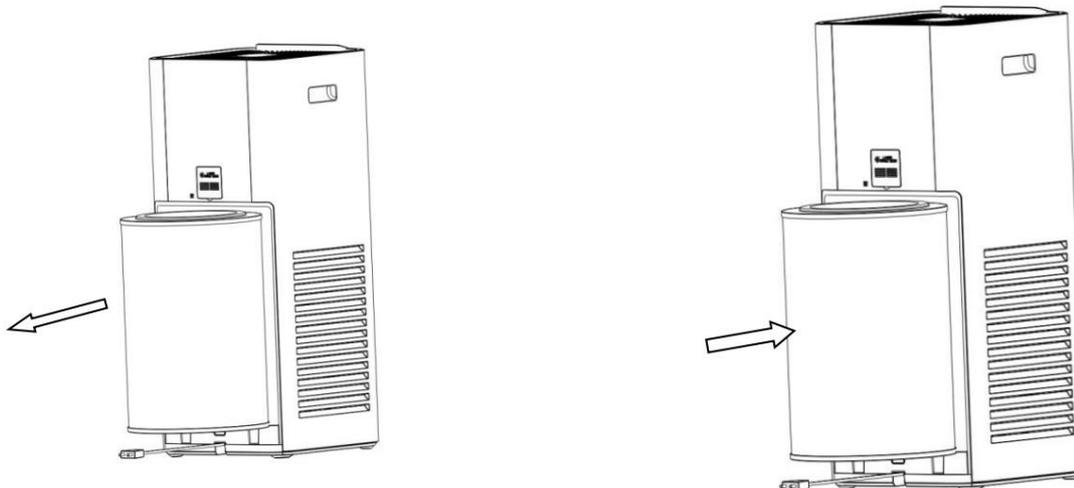
7> Verrouillez le filtre H13 : poussez le bloc de verrouillage du filtre vers l'avant comme indiqué ci-dessous
