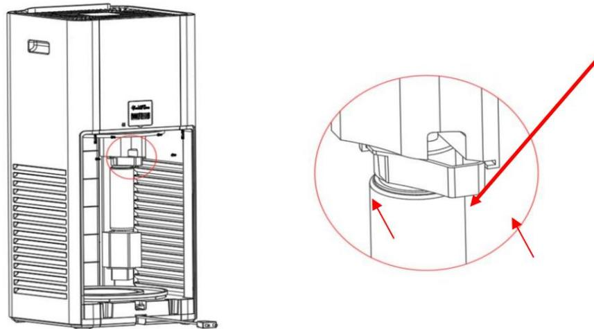
6> Chargez le nouveau filtre H13 : Placez le nouveau filtre H13 sur le plateau de verrouillage. (Remarque : il est nécessaire de placer le filtre avec la languette vers à l'utilisateur)
